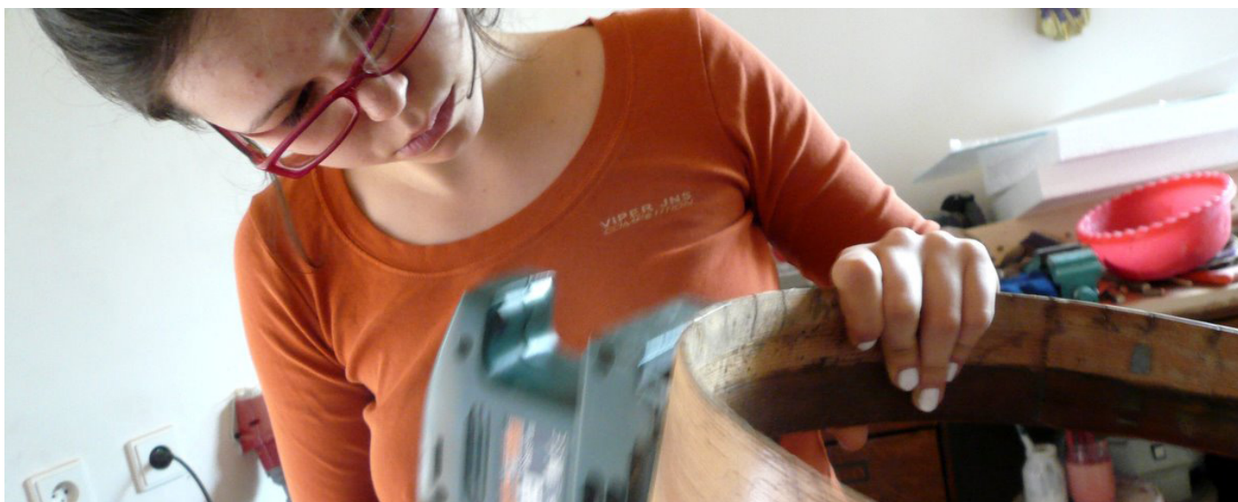
Obr. 34. Broušení obruče ze síta
