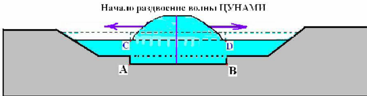
Цунами. Рисунок 15 – 4. Начало раздвоение водной горы над эпицентром землетрясения.
