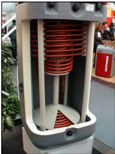
Obrázek č. 11 – Moderní zásobníky na TUV mohou k ohřevu vody využívat více zdrojů energie. Pohled do nitra zásobníku se systémem trubkových výměníků pro různé zdroje tepla.
