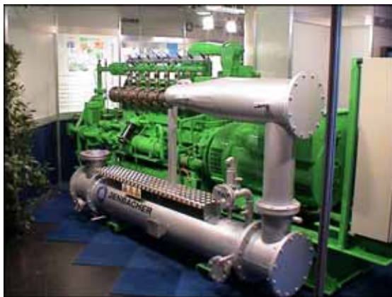
Obrázek č. 33 – Velká kogenerační jednotka.
