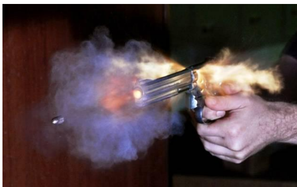
Na snímku je patrný výsledek plamene mezi ústím bubínku a hrdlem hlavně revolveru při výstřelu
