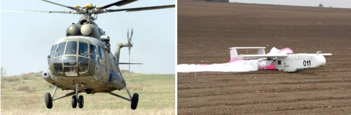
Vrtulník Mila Mi-17 s kamerou pro noční vidění (malá kopule pod trupem) a bezpilotní letoun Sojka III
