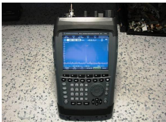
Portable receiver for mobile radio monitoring R&S PR100 , na němž právě šmíruji dopravní policii v BDY
