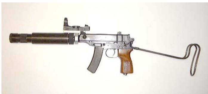
Samopal vz.61 (náboj 7,65 mm Browning ) s přídavným tlumičem snižujícím hluk střelby o 35 dB
