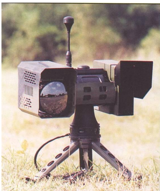
Lehký průzkumný a pozorovací komplet OKO (bez zdrojů elektrického napájení) vlevo je sensorová část a vpravo ovládací terminál s monitorem
