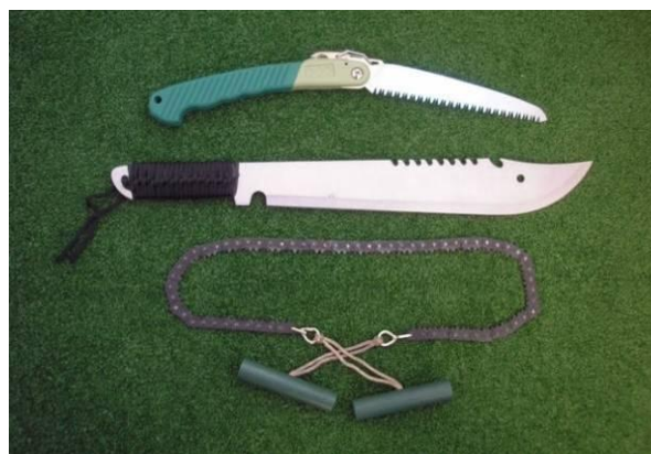
Zahradnická zavírací pila (optimální pro průměry kmenů a větví 5–10 cm), mačeta (pro průměry do 5 cm) a ruční řetězová pila (bez potíží položí i 30 cm smrk)
