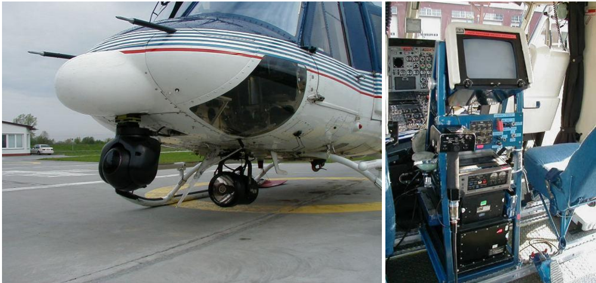
Policejní vrtulník Bell 412HP na snímku vlevo je kamera pro noční vidění FLIR 2000FN vpravo vyhledávací reflektore Spectrolab SX-16 Nighsun , na snímku vpravo je ovládací panel a monitor v kabině vrtulníku
