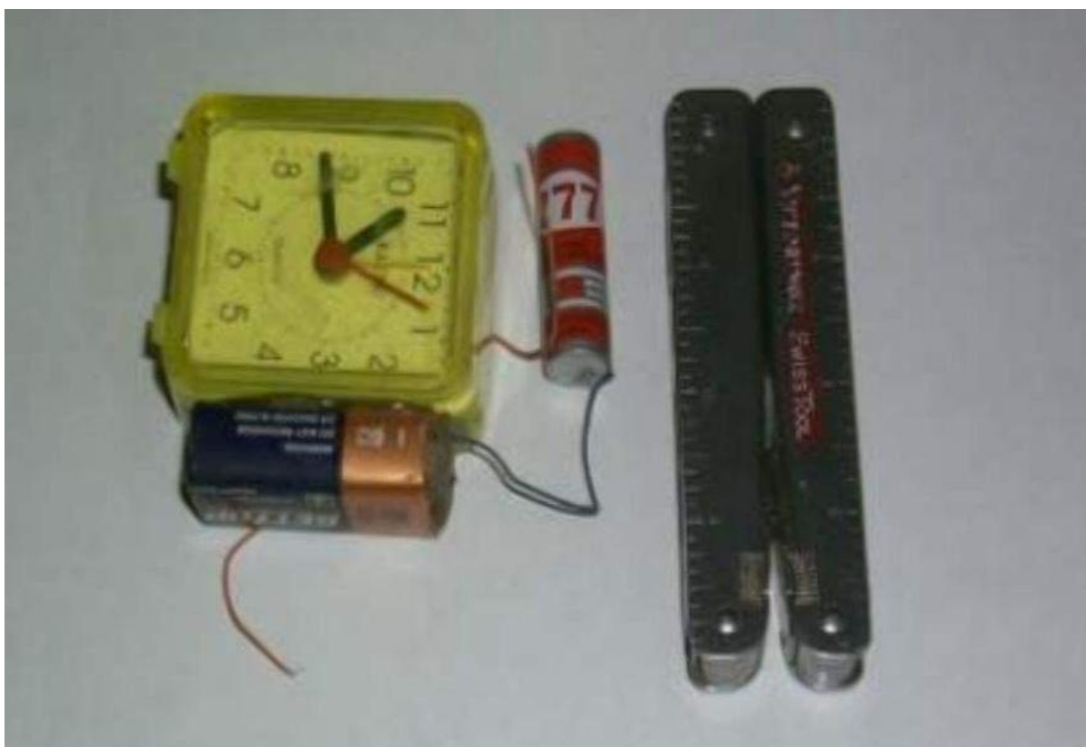
Časový spínač ze starého budíku, z hlediska principu patří spíše mezi elektronická zařízení
