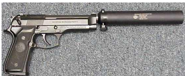
Pistole Beretta 92F (náboj 9 mm Luger ) s přídavným tlumičem snižujícím hluk výstřelu o 38 dB
