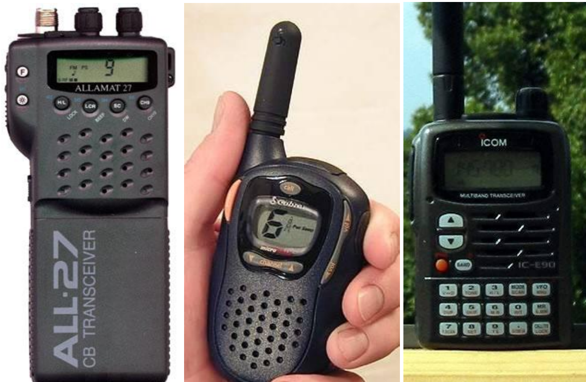
CB radiostanice ALLAMAT 27 pro pásmo 27 Mhz, PMR radiostanice Mikrotalk pro pásmo 446 Mhz a radiostanice ICOM E90 pro provoz v ostatních občanských pásmech
