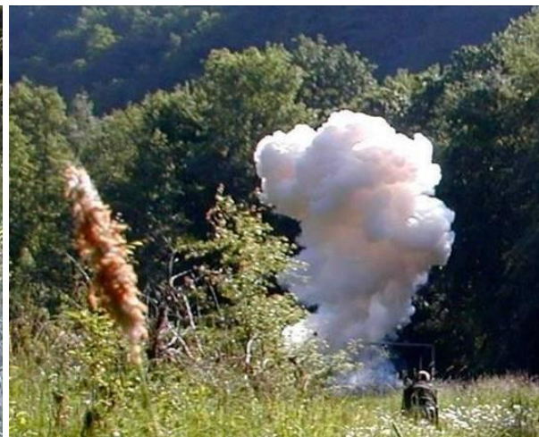
Názorná ukázka výbuchu nálože 0,5 kg Dynamonu 12 s elektrickým roznětem EPIO a rozbuškou 4 g HMTD
