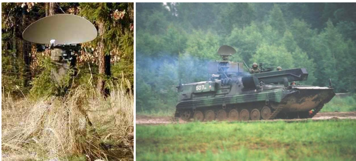
Přenosný radiolokátor SCB 2130 L-2 Sova a průzkumný a pozorovací komplet Sněžka , oba systémy používají stejný izraelský radiolokační systém s obdobnými TTD
