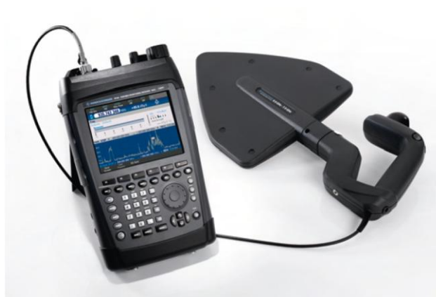
Scanner R&S PR100 anténou R&S HE 300 . Prostou triangulační metodou jste schopni zjistit pozici /pohyb jakéhokoli vysílače podle vzdálenost s přesností na stovky až desítky metrů
