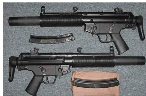
Samopal Heckler & Koch GmbH MP5SD3 (náboj 9 mm Parabellum ) s integrálním tlumičem snižujícím hluk střelby o 38 dB
