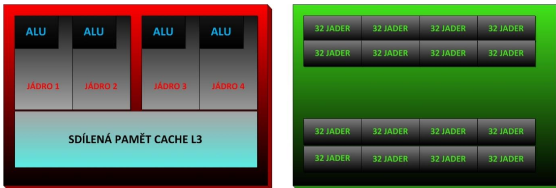
Obr. 1.1 Porovnání struktury CPU a GPU
