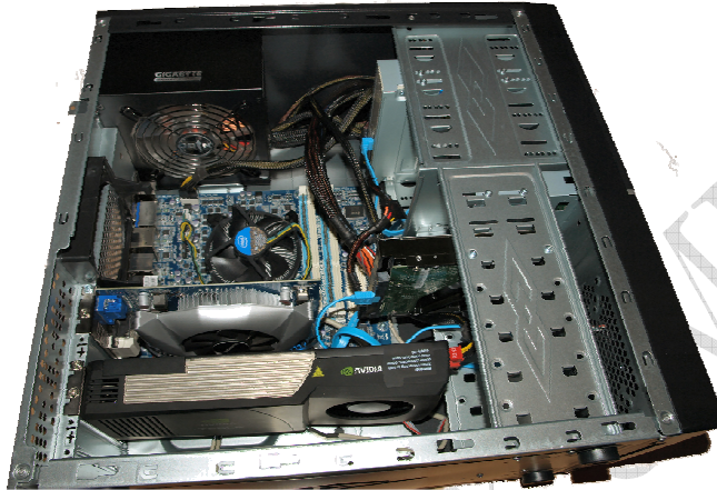
Obr. 7 Osadené nVIDIA TESLA c1060 a nVIDIA GT240 (KPI FEI TU Košice)
