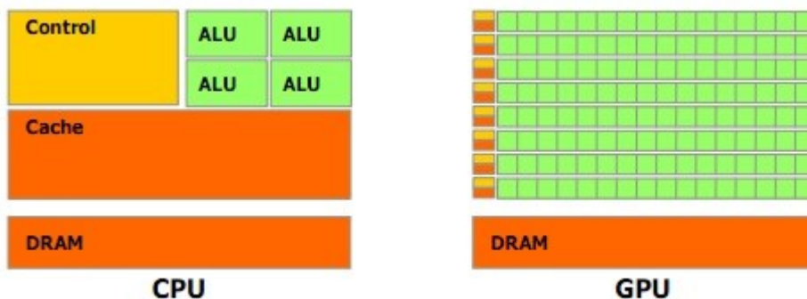
Obrázek 2: Architektury CPU a GPU
