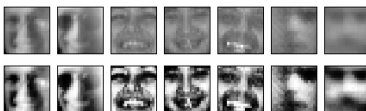
Obr. 3.5: Korekcia kontrastu pomocou histogramovej ekvalizácie
