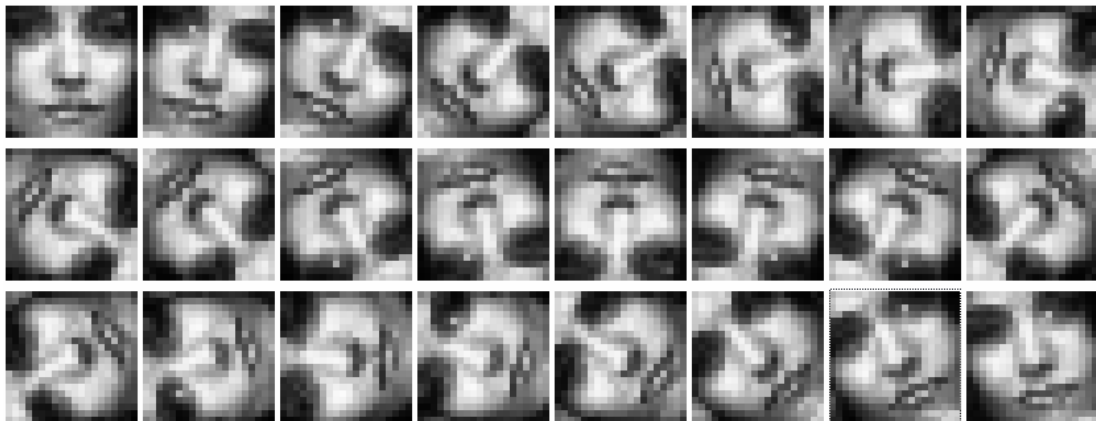
Obr. 3.7: 24 normalizovaných vzoriek vhodných na tréňovanie neurónovej siete pre klasifikáciu natočenia tváre ( R=24 ). Ide o vzorky vytvorené rotovaním po 15^\circ ( 0^\circ, 15^\circ, 30^\circ, 45^\circ, 60^\circ, 75^\circ, 90^\circ, 105^\circ, 120^\circ, 135^\circ, 150^\circ, 165^\circ, 180^\circ, 195^\circ, 210^\circ, 225^\circ, 240^\circ, 255^\circ, 270^\circ, 285^\circ, 300^\circ, 315^\circ, 330^\circ, 345^\circ )
