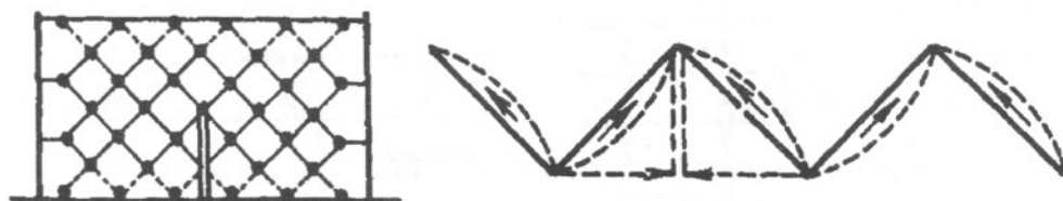
Obr. 13.10 Napájení KV dipólových stěn; rozložení proudu podél vodiče jednoho patra
