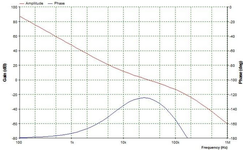
Obr. 63 Zisk otevřené smyčky (pro 2 GHz) simulovaný programem ADIsimPLL
