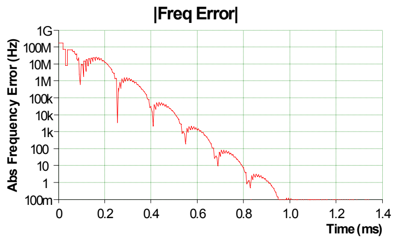
Obr 14 : Ustálení ADF4360 – simulace
