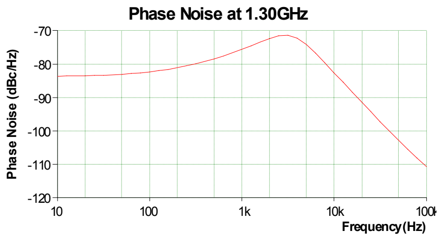
Obr 13 : Fázový šum ADF4360 – simulace
