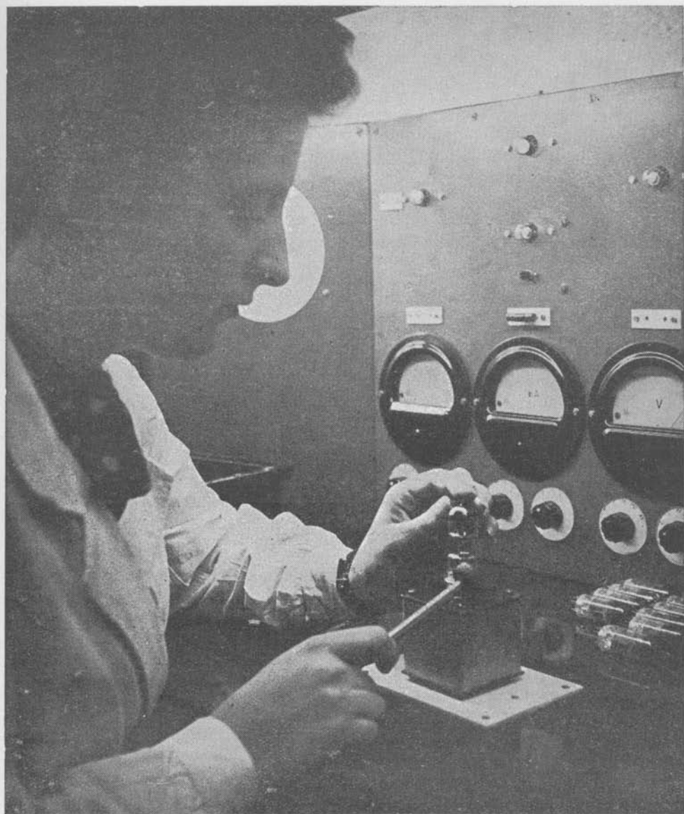
Obr. 18. Kontrola elektronky na tzv. chrasticím stole
