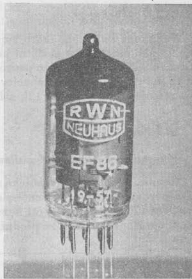
Obr. 78. Pentoda EF86 vyrobená v závodech RFT (NDR)
