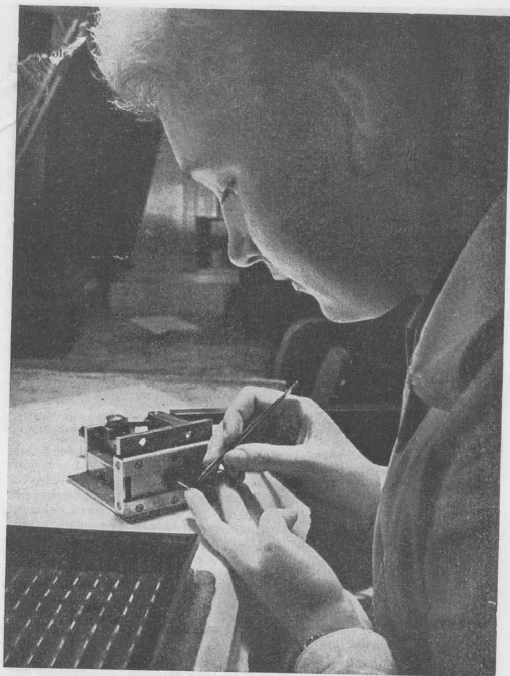
Obr. 26b. Vnitřní rozpínání mřížky triody ECC84 na požadovaný tvar
