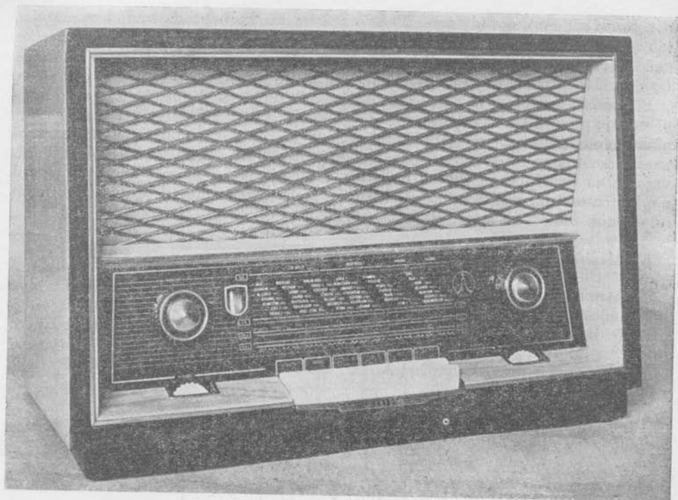
Obr. 67. Čs. superhet Rondo (2 × ECH81)
