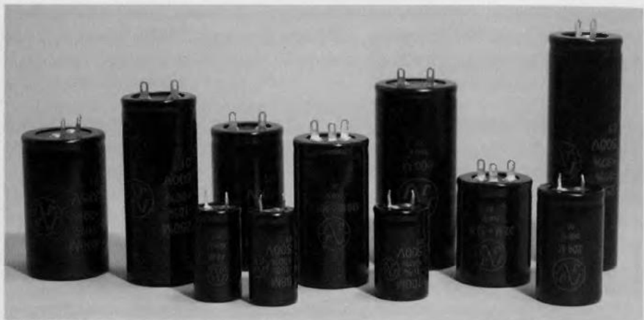
Obr. 11.10 JJ electronic vyrábí nejen elektronky, ale i široký sortiment elektrolytických kondenzátorů, především vícenásobných, které nacházejí své uplatnění v elektronkových zesilovačích
