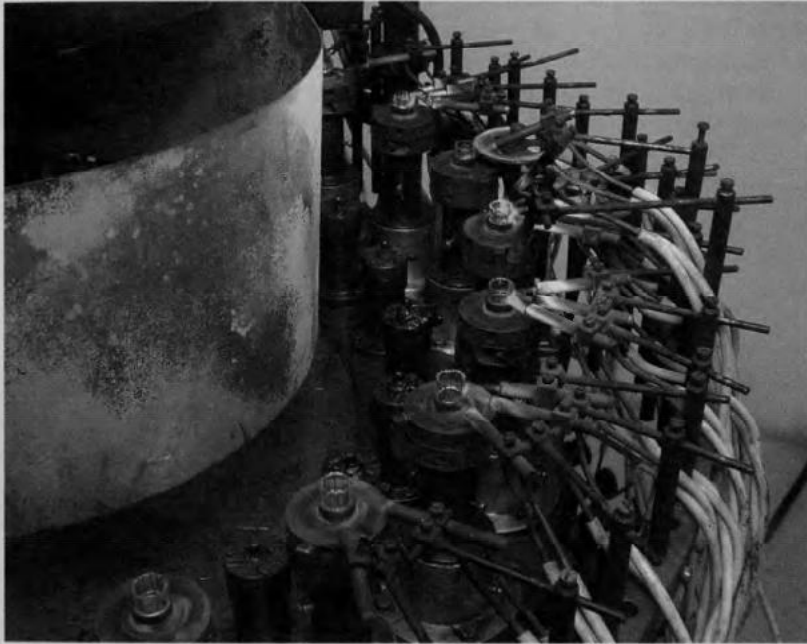
Obr. 11.3 Karuselový automat na výrobu skleněných patic
