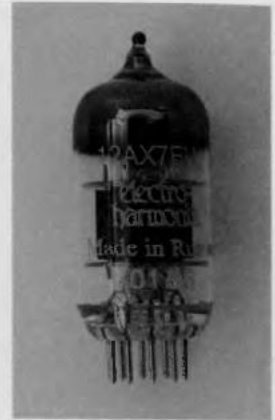
Obr. 8.5 12AX7EH je elektronka vyrobená v Rusku pro dříve americkou, nyní ruskou firmu ELECTRO-HARMONIX. Je určena pro americký trh, proto má značení 12AX7EH, což je jiné než je v Rusku běžné.
