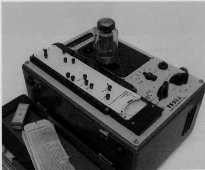
Obr. 8.13 Tester elektronek TESLA
