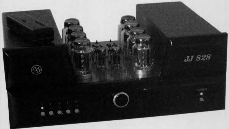
Obr. 9.3 Zesilovač JJ 828 pracující ve třídě AB s dálkovým ovládáním. Výstupní zesilovač zajišťuje výkon minimálně 50 W (typ. 70 W) na kanál. Osazení: vstup 4 × ECC82 a 2 × ECC99, koncový zesilovač 8 × KT88.
