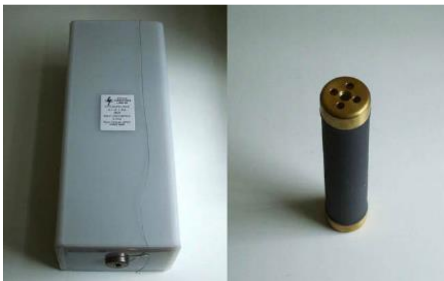
Obr. 7.2: vybíjanie kondenzátorov impulz 50kVA (vľavo) a odolnosť 70kV, 55W (de- Xia). Rezistory 1 MO a 10MO majú zhodné rozmery.
