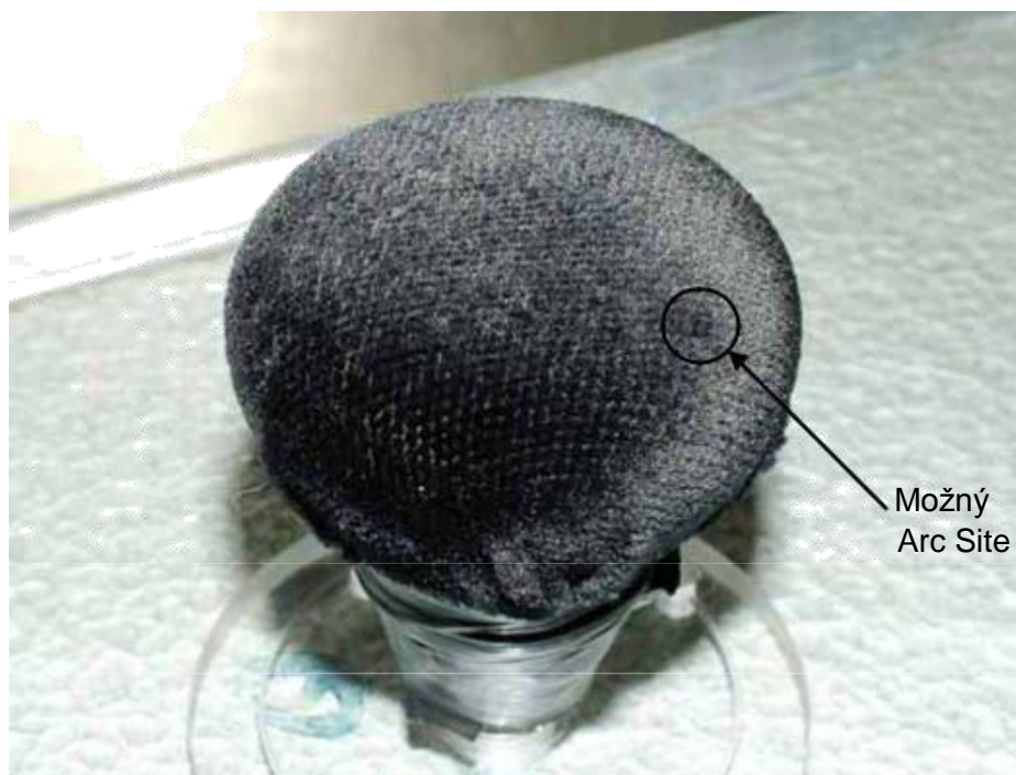
Obr. 6.85: Descent tkanina, DAK = 15mm, ~ 100 dopady. Vzalo na vedomie iba viditeľné znamenie, ktoré sa objavilo po vyšetrení tkaniny.
