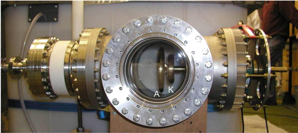
Obr. 4.23: Vircator typ Reflex trioda. Pulz je poháňaný stúpať. Vľavo je prispôsobený vákuové čerpadlo (nie je vidieť), cez dielektrikum keramické styčných miest, pre elektrickú izoláciu čerpadla z impulzov krajine [116].
