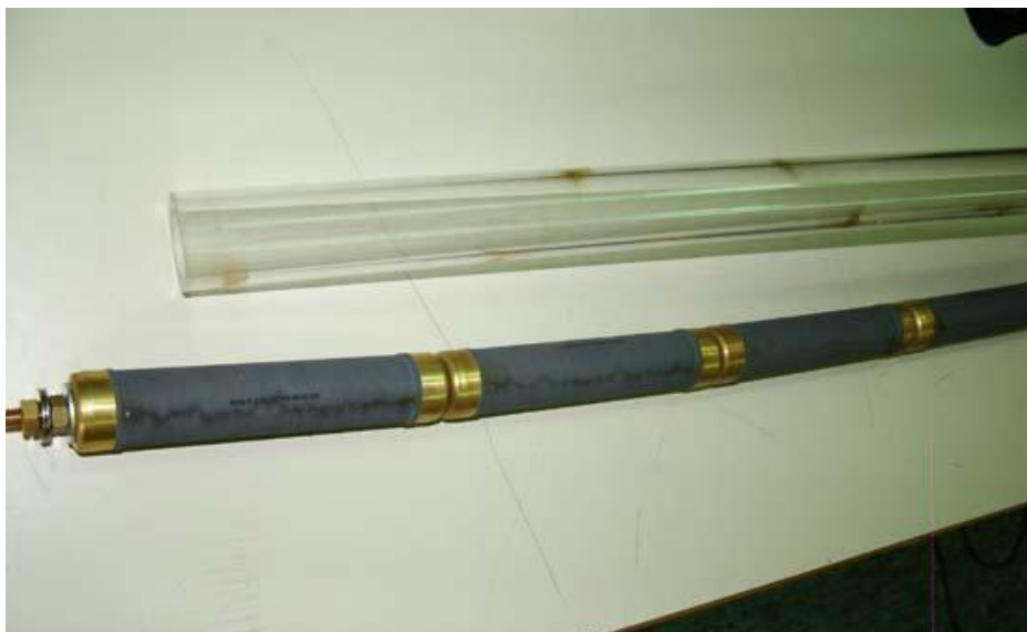
Obr. 7.32: Vysoká napätie delič rezistory. Distinguished značka vašich erpou- povrcho- vypúšťanie odporov a znamenie v akrylové rúrke.
