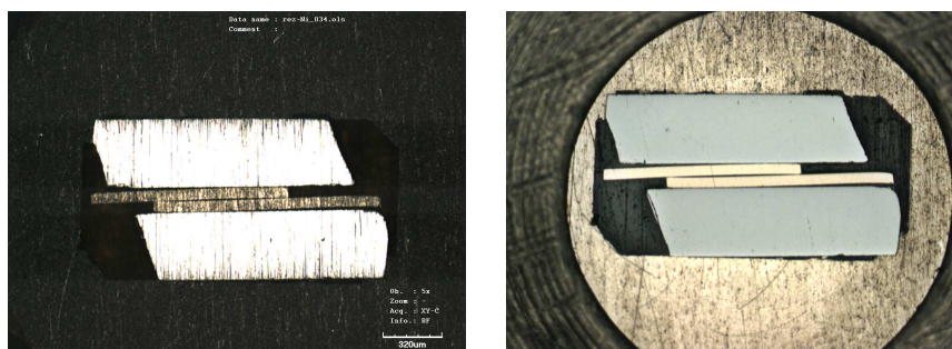
Obrázek 18: Snímky z konfokálního mikroskopu: vlevo po broušení, vpravo po iontovém leptání.
