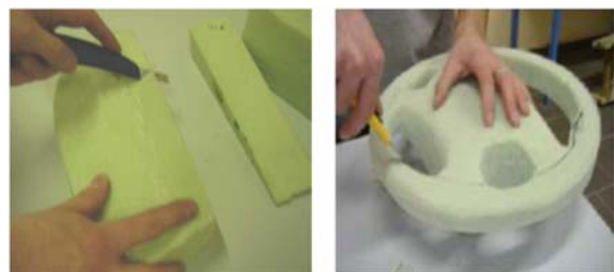
Obr. 3: Vyrezávanie tvaru na hrubo [2]
