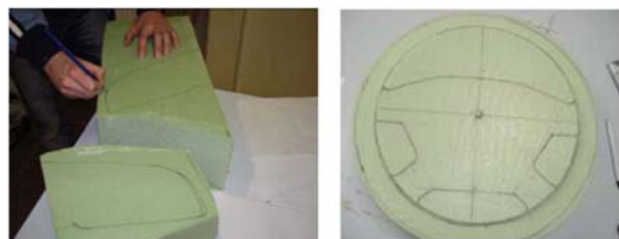
Obr. 2: Príprava polotovaru – prekresľovanie skice na materiál [2]
