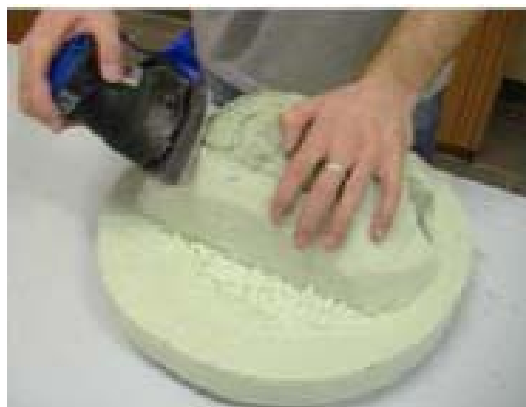
Obr. 3: Vyrezávanie tvaru na hrubo [2]
