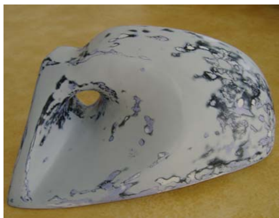
Obr. 6: Model po konečnom zatmelení a brúsení, pripravený na nastriekanie farby [2]
