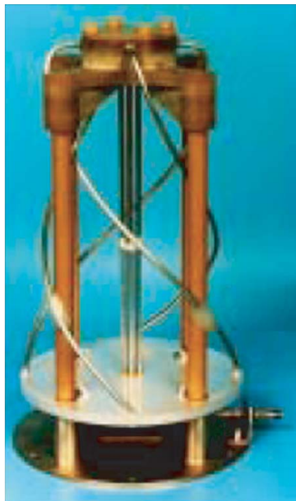
Fig. 4-15. Mars Odyssey four-arm quadrafil helix UHF antenna.
